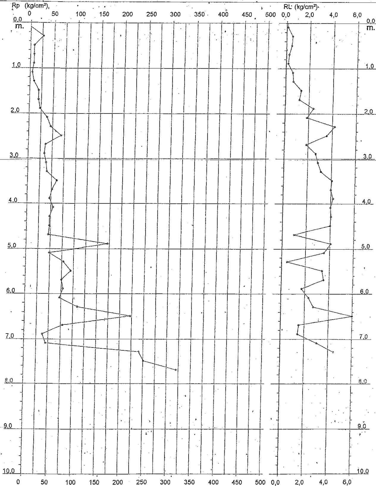
**PROVA PENETROMETRICA STATICA
